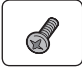
مسامير M4 x 12 (4) (تستخدم لتثبيت الجانب العلوي مع الجانب السفلي للخرانة)
